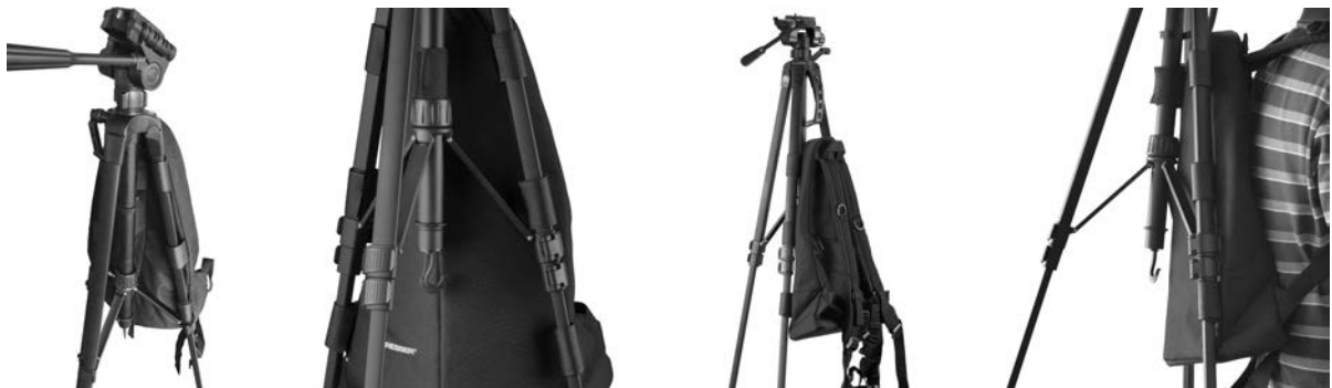
Abb. 4: Anbringen des Stativs am Rucksack für den Transport.
