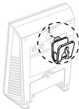
Bringen Sie eine Schraube an der Wand an, an der Sie den Sensor aufhängen möchten. Stecken Sie den Sensor mit oder ohne Montageadapter auf die Schraube.
