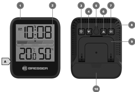
Fig. 1: Todas as peças do sensor térmico/higrómetro
