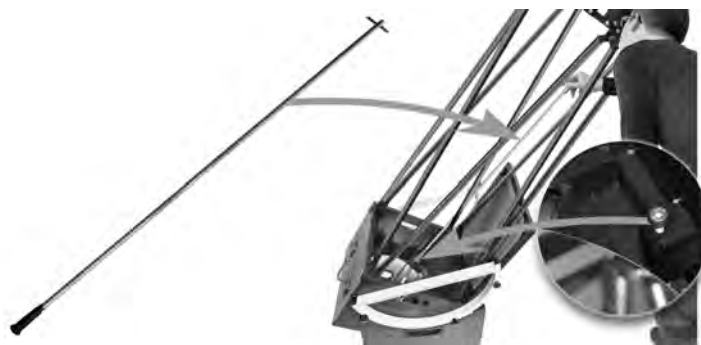
Fig. 6: Alineación del espejo principal con una herramienta especial
