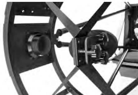
Fig. 5: Alineación del espejo mediante los tornillos de alineación
