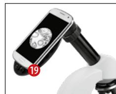
L'adaptateur de Smartphone est fixé à l'oculaire du microscope.
