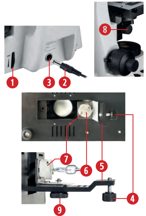
Abb. 10: Lampenwechsel durchführen.
