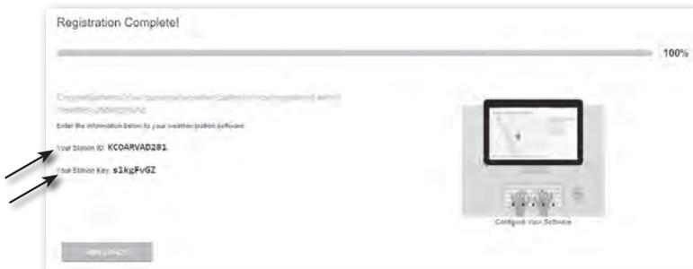
8. En la interfaz de configuración mencionada en el **apartado 5.2**, seleccione Weather Underground en la primera o segunda fila de la sección de configuración del servidor meteorológico y, a continuación, introduzca la ID de la estación y la clave asignadas en Weather Underground.
