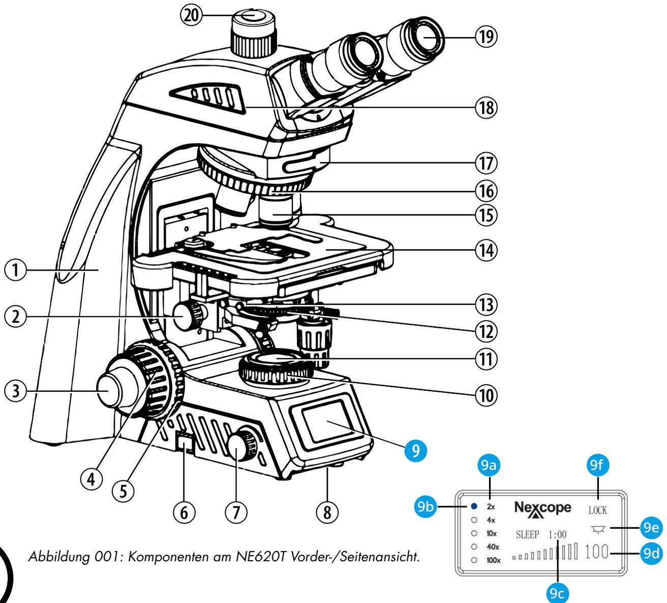
Abbildung 001: Komponenten am NE620T Vorder-/Seitenansicht.
