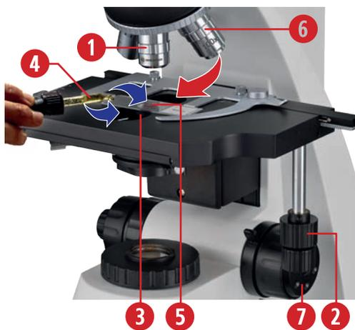
Fig 10 : Utilisation de l'objectif à immersion dans l'huile 100x.
