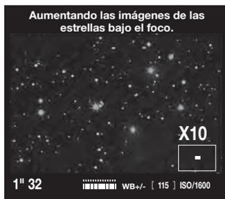
Nota: La imagen de la estrella puede desenfocarse por el mal funcionamiento de la función de autoenfoque de la cámara si se presiona el disparador después de enfocar la estrella. Para evitarlo, asegúrese de que la función de autoenfoque esté ajustada en OFF.
