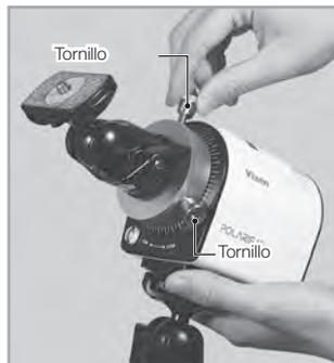
Monta tu cámara en la cabeza de la bola 2. Fijar la cámara en la cabeza de la bola 2 con el tornillo de la cámara acompañado de la cabeza de la bola.
