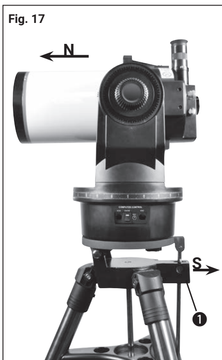
Azimutale Ausrichtung: Neigeplatte und Tubus stehen waagrecht. Die Tubus-Öffnung zeigt nach Norden (N)
