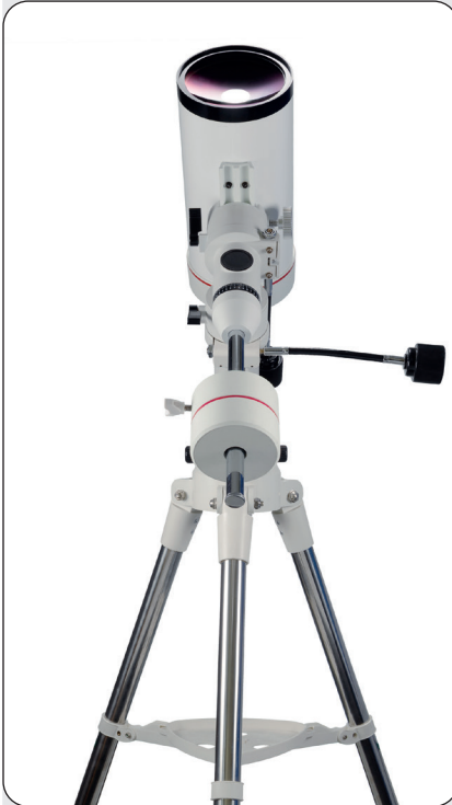
Abb. 4: Die parallaktische Grundposition von Norden gesehen.
