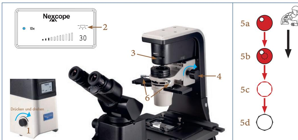
Abbildung 053: NIB630 – Zentrieren des Kondensors.
