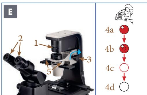
Abbildung 055 E: NIB630 – Zentrieren des Kondensors.
