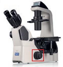
**💡** Ist der Friktiontrieb zu locker eingestellt, senkt sich der Objektivrevolver unter seinem eigenen Gewicht zu stark ab. Dies führt beim Beobachten zu einem Verlust der Bildschärfe. Stellen Sie daher das Drehmoment entsprechend ein.
