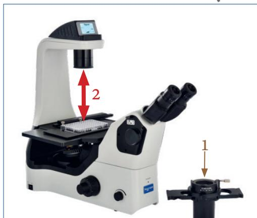
Bei Verwendung von Kulturflaschen kann der Kondensator (1) einfach entfernt werden. Der Arbeitsabstand (2) vergrößert sich von 75 mm auf 187 mm. Eine hilfreiche Funktion bei der Arbeit mit Zellkulturflaschen und Mehrschicht-Kulturflaschen (Stacks).
