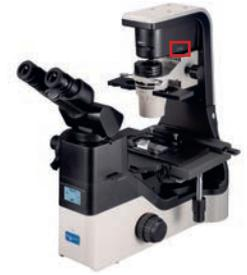
Abbildung 048: NIB630 – Hebel zum Abblenden.
