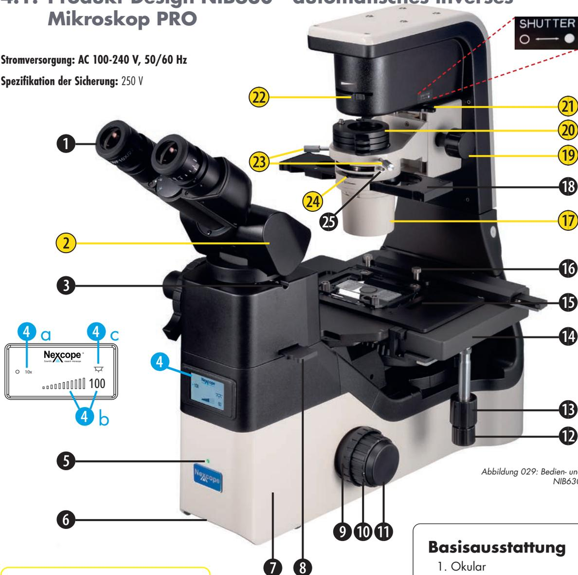
Abbildung 029: Bedien- und Funktionselemente am NIB630 Vorder-/Seitenansicht.
