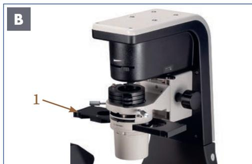
Abbildung 055 B: NIB630 – Phasenkontrast-Schieber einstellen.
