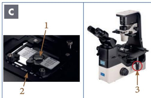
Abbildung 055 C: NIB630 – Probe auf dem Kreuztisch platzieren.
