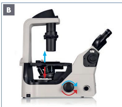
Abbildung 019: NIB610/NIB620 - Fokussiermechanismen.
