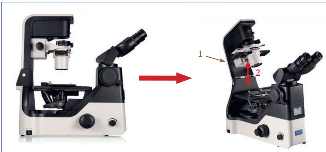
Abbildung 049: NIB630 - Kippbare Beleuchtungseinheit.
