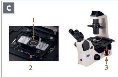
Abbildung 028 C: NIB610/NIB620 – Präparat auf dem Kreuztisch platzieren.
