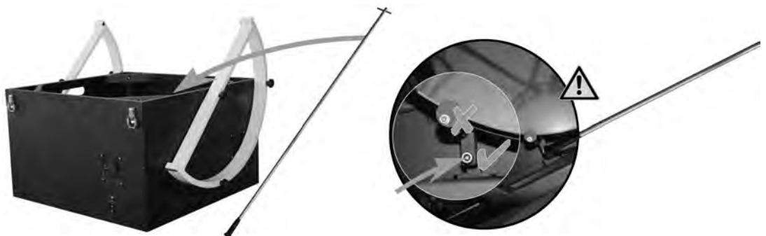
Abb. 10: Hauptspiegeljustierung mit Kollimationswerkzeug
