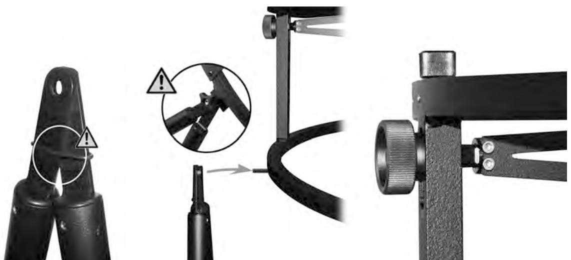
Abb. 5: Montage der Streben (links) und Justierschrauben (rechts) am Fangspiegelkäfig.
