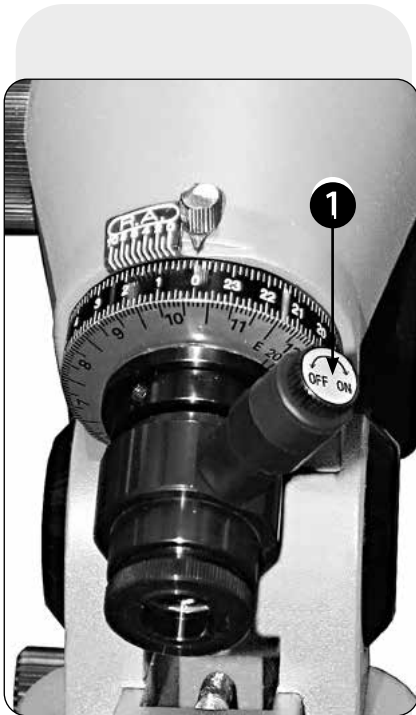
Abb. 6: Detailansicht Polsucherfernrohr mit Drehschalter (ON/OFF)
