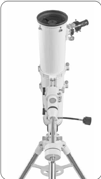
Abb. 3b: Die parallaktische Grundposition – hier bei einem Newton – von Norden gesehen.
