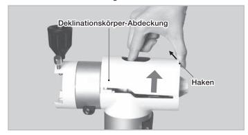
3 Lösen Sie die beiden Innensechskantschrauben am Deklinationskörper wie in der Abbildung gezeigt mit dem 4-mm-Innensechskantschlüssel.
