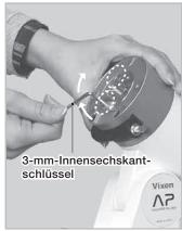
13 Bringen Sie den Deklinationskörper so am AP Polachsenkörper an, dass der elektrische Kontakt am Deklinationskörper in die Vertiefung an der manuellen Feineinstellung passt.
