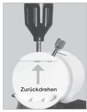
2 Befestigen Sie den Teleskop-Tubus am Montierungskopf, sodass die Schwalbenschwanz-Aufsatzplatte sicher in den Montierungskopf passt. Ziehen Sie zuerst die Schwalbenschwanzplatten-Feststellschraube auf der Zentrierkerbe der Schwalbenschwanz-Aufsatzplatte an, bis sie fest sitzt. Ziehen Sie dann die Sicherheitsschraube fest an.
