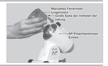
12 Drehen Sie das manuelle Feineinstellungsmodul so, dass die Schraubenlöcher (größere Löcher ohne Gewinde) deckungsgleich sind. Setzen Sie die drei Innensechskantschrauben wieder ein.
