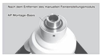
5 Befestigen Sie das R.A.-Motormodul so auf der AP Montage-Basis, dass der elektrische Kontakt nach außen zeigt, wie in der Abbildung gezeigt.
