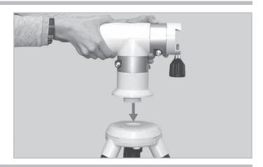
6 Halten Sie den Montierungskörper in einer Hand und heben Sie die Mittelsäule mit der anderen Hand an, sodass die Oberseite der Säule in die Unterseite der Halterung passt. Drehen Sie die Mittelsäule gegen den Uhrzeigersinn, um den oberen Teil der Säule in dem unteren Teil der Montierung zu verschrauben, bis diese fest sitzt.
