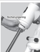
18 Entfernen Sie die Sicherungsschraube am Ende der Gegengewichtsstange.
