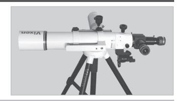
2 Lösen Sie die Feststellschraube und die Sicherungsschraube am Montierungskopf, die die Schwalbenschwanzschiene des Teleskops halten, und schieben Sie die Schwalbenschwanzschiene entweder nach vorne oder nach hinten, bis der Teleskop-Tubus stehen bleibt.
