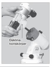
14 Setzen Sie die beiden Innensechskantschrauben, die in Schritt 3 oben entfernt wurden, wieder ein, während Sie den Deklinationskörper mit einer Hand festhalten.
