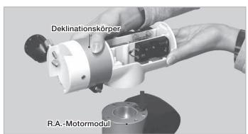
8 Setzen Sie die beiden Innensechskantschrauben, die in Schritt 3 oben entfernt wurden, wieder ein, während Sie den Deklinationskörper mit einer Hand festhalten. Setzen Sie die Batterien ein, falls erforderlich. Ziehen Sie die Schrauben mit dem 4-mm-Innensechskantschlüssel fest an.
