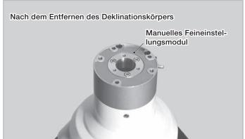
4 Lösen Sie die drei Innensechskantschrauben am manuellen Feineinstellungsmodul mit dem 3-mm-Innensechskantschlüssel. Entfernen Sie das manuelle Feineinstellungsmodul.
