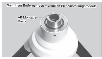
5 Entfernen Sie die AP Montage-Basis vom Stativkopf. Lösen Sie die Feststellschraube für die Beinstreben und heben Sie die Beinstreben an, sodass Sie die Mittelsäule drehen können. Die AP Montage-Basis löst sich, wenn Sie die Mittelsäule im Uhrzeigersinn drehen. Halten Sie die AP Montage-Basis mit einer Hand fest, um zu verhindern, dass sie sich zusammen mit der Mittelsäule dreht.
