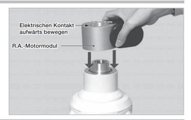
6 Drehen Sie das R.A.-Motormodul, um die Schraubenlöcher deckungsgleich zu bekommen. (größere Löcher ohne Gewinde) Setzen Sie die drei Innensechskantschrauben wieder ein und ziehen Sie die Schrauben mit dem 3-mm-Innensechskantschlüssel fest an.
