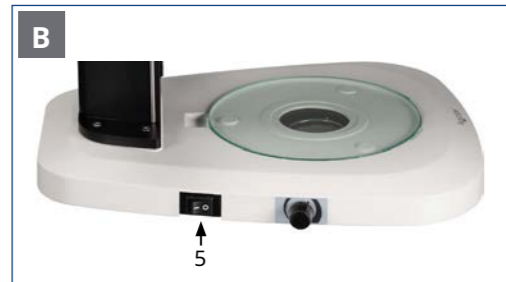
Abbildung 011 B: Das Mikroskop starten.
