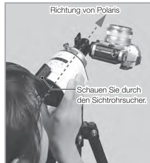
4 Sehen Sie durch den Sucher des Visierrohrs, um zu sehen, ob Polar is irgendwo im Sichtfeld zu sehen ist, und zentrieren Sie dann Polar is im Sichtfeld, indem Sie die Ausrichtung des Stativs anpassen.
