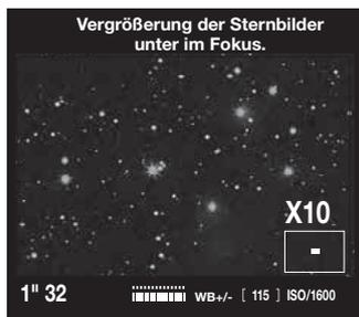
Hinweis: Das Sternbild kann durch eine Fehlfunktion der Autofokussfunktion der Kamera unscharf werden, wenn Sie den Auslöser drücken, nachdem Sie den Stern scharfgestellt haben. Um dies zu vermeiden, vergewissern Sie sich, dass die Autofokussfunktion auf OFF gestellt ist.
