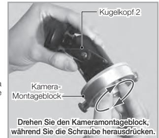
Drehen Sie den Kameramontageblock, während Sie die Schraube herausdrücken.
