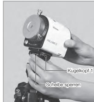
Die POLARIE U ist wahlweise für ein Stativ mit 1/4" oder 3/8" Schraube erhältlich. Ein Umrüstadapter für 1/4"-Schrauben ist bei Vixen werksseitig auf einem der Stativgewindesockel vorinstalliert. Wenn Sie ein Stativ mit einer 3/8"-Schraube verwenden, entfernen Sie vorab den Umbauadapter für 1/4".
