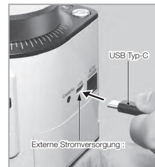
Wenn Sie die externe Spannungsversorgung bei eingelegten Batterien anschließen, hat die externe Spannungsversorgung aufgrund ihrer höheren Spannung Vorrang vor den Batterien.
