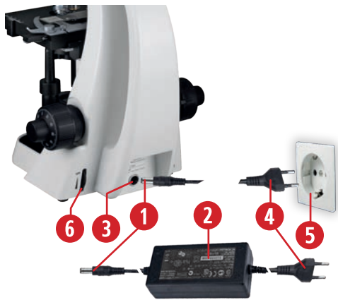
Fig. 2.: Establecer la conexión a la red y ajustar la iluminación.
