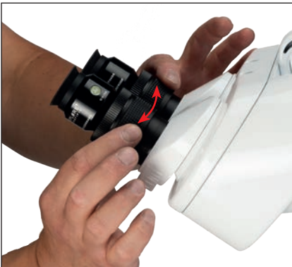
17. Fokussieren mittels Helical-Einzelfokussierung.
