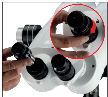
16. Okulare einsetzen und festklemmen.
