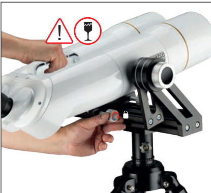
11. Fernglas am Tragegriff halten und Fixierschrauben anziehen.
