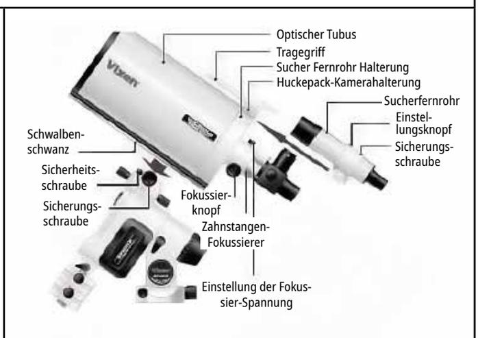
(Hier sind die SX-Montierung und der optische Tubus VMC200L abgebildet)
