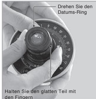
Wenn der Beobachtungsort östlich (=East) des Standardzeitmeridians liegt, rotieren Sie den Indexring des Zeitzone-meridians in Richtung E, bis der erforderliche Wert auf der Längenkorrekturskala angezeigt wird.
