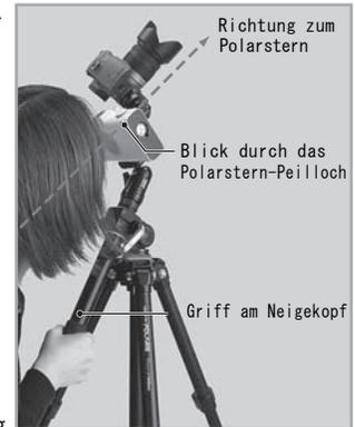
Anmerkung: Falls der Blick durch das Peilloch durch die Kamera blockiert ist, drehen Sie diese oder nehmen Sie sie kurzzeitig ab.
