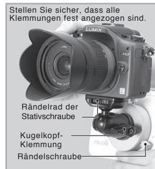
Anmerkung: Stellen Sie sicher, dass dabei die Kamera nicht zu Boden fallen kann. Und achten Sie darauf, dass alle Klemmungen und Schrauben sicher angezogen sind. Zumindest Ihre Kamera könnte sonst beschädigt werden.
